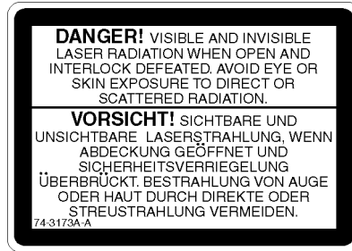
Figure 37: Door Interlock Danger label
